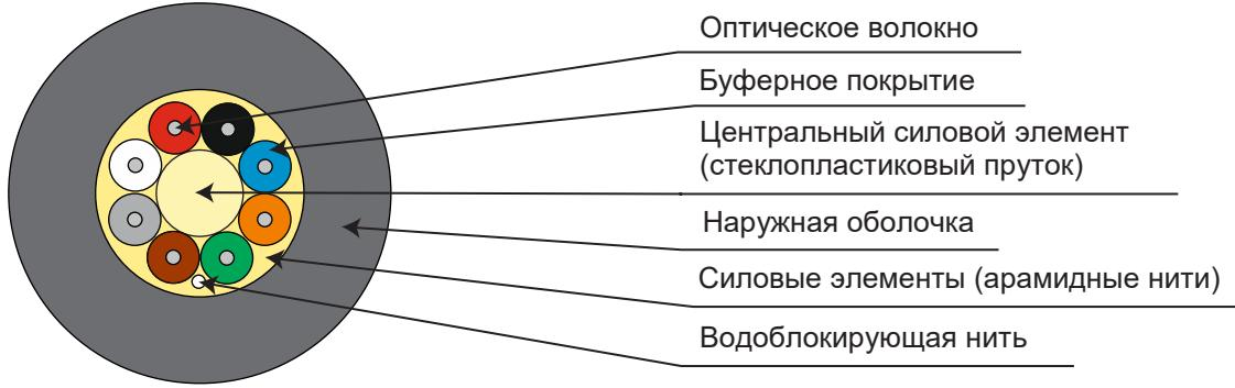
Кабель 2-4 ОВ содержит пучок оптических волокон в буферном покрытии и водоблокирующей нить, на которые наложен слой упрочняющих арамидных нитей с водоблокирующим эффектом.
