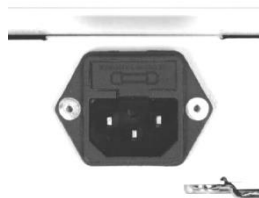
Разъём питания вентиляторного блока с терморегулятором и датчиком
