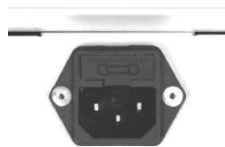
Разъём питания вентиляторного блока с терморегулятором и датчиком
